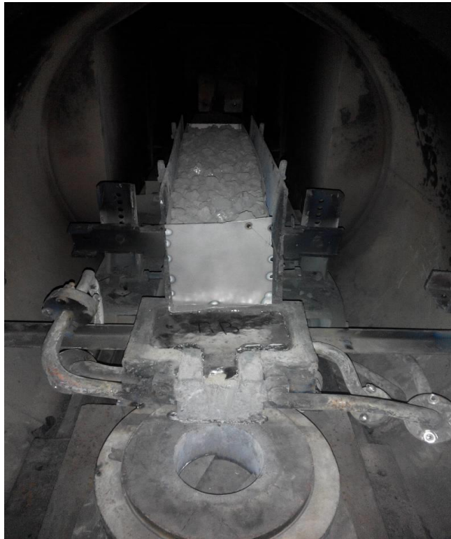
Рисунок 3.1 – Камера для плавлення титанових брикетів в установці УЕ-208
