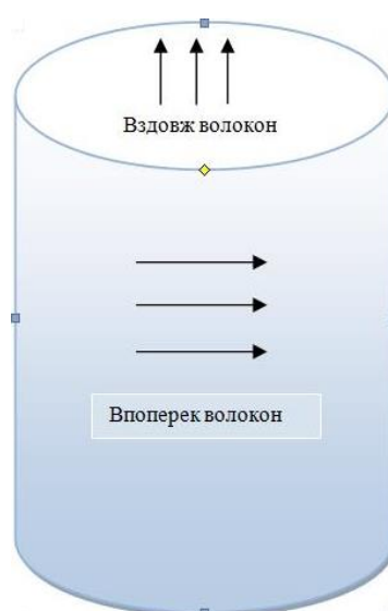
Рисунок 7.5 – Схема розташування волокон в кристалі Ti-TiV, вирощеному на установці «Кристал-206»
