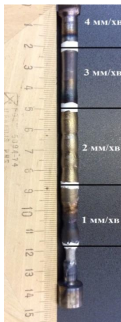
Рисунок 2.7 – Кристал композиту Ti-TiB, виготовлений на установці «Кристал-206»
