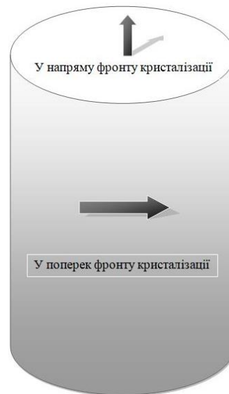
Рисунок 3.2 – Схема розрізання вилівку композиційного матеріалу Ti-TiB, виготовленого електронно-променевою плавкою на установці UE-208
