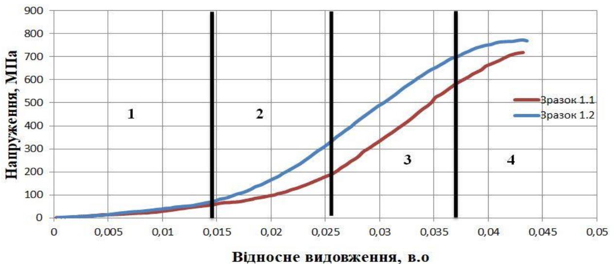
Рисунок 5.6 – Діаграма напруження – деформація при швидкості деформації 2 мм/хв. для сплаву Ti-TiB, отриманого шляхом ЕПП
