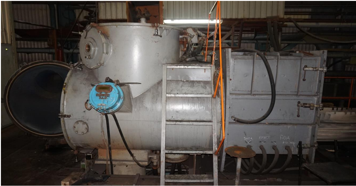
Рисунок 2.2 – Зовнішній вигляд лабораторної електронно-променевої установки UE-208
